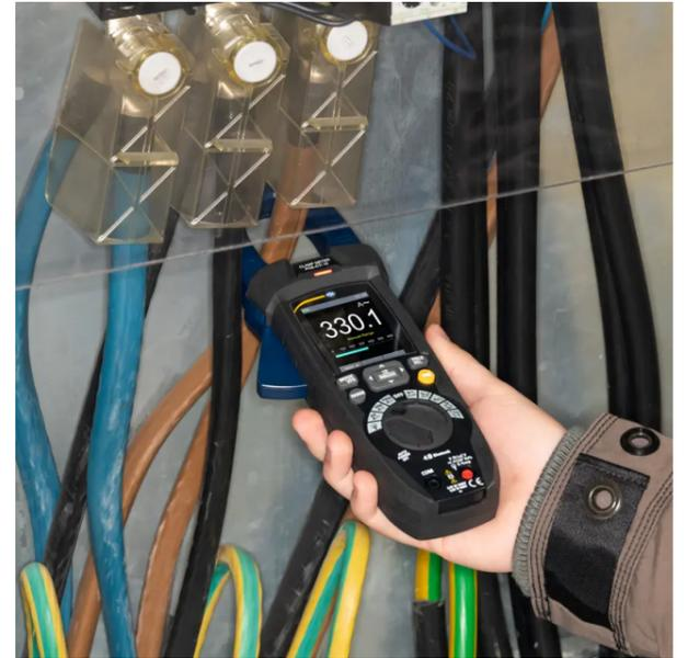
**Amperemeter mit Bluetooth 4.0 Schnittstelle / Messbereich 0 ... 1500 V AC/DC /
